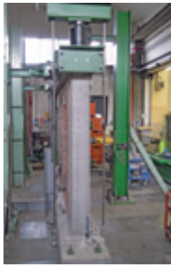
Fig. 2 - Vista laterale del sistema di prova, e curva di carico delle prove fuori piano.
