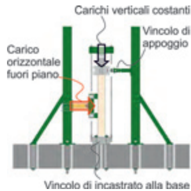
Fig. 2 - Vista laterale del sistema di prova, e curva di carico delle prove fuori piano.
